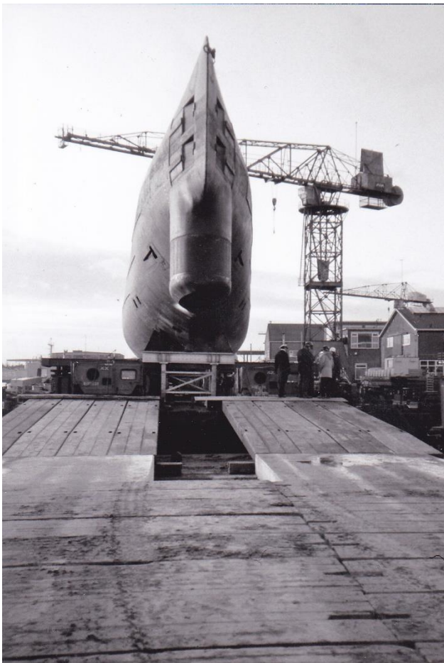
De oprit naar het ponton. Ter weerszijden van het voorste portaal zijn de voor-kanten van de voorste twee wagens zichtbaar, met motor en bedieningspaneel.
